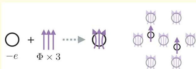
図2 (左) 分数量子ホール状態における複合粒子の概念図。ひとつの電子に3つの磁束量子 $\Phi$ が結合する例。(右) 複合粒子の凝縮体中に現れる分数電荷 $-e/3$ をもつ準粒子の概念図。
