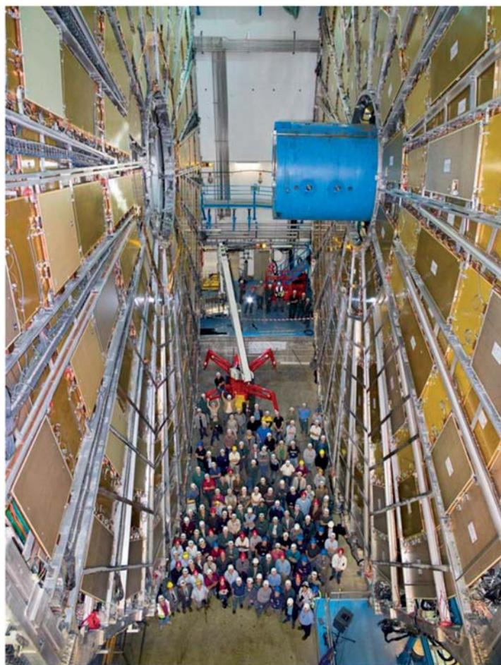
図：完成した ATLAS 実験エンドキャップ部ミュオントリガー用検出器（通称 Big Wheel）。これを構成する TGC は、イスラエル・日本・中国の共同により製作された。
