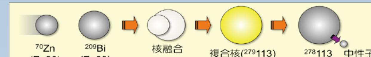
図4 113番元素が合成される過程。 ^{209}\text{Bi} 標的に ^{70}\text{Zn} ビームを照射して ^{278}\text{113} を合成した。この時の原子核反応を ^{209}\text{Bi}(^{70}\text{Zn}, n)^{278}\text{113} と表記する。
