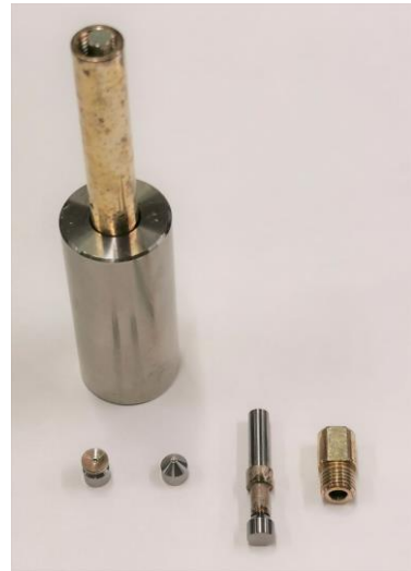
図 1 高压磁化測定で得られた \text{K}_2\text{RuCl}_6 の磁化-温度曲線 (左) と測定に使用した高压装置 (右). 左図で様々な圧力・温度範囲で得られた測定結果は高压装置を使用せずに得られた参照データ (黒線、 \text{Ru}^{4+} のバンブレック常磁性は圧力に殆ど依存しない) と誤差内で一致している.
