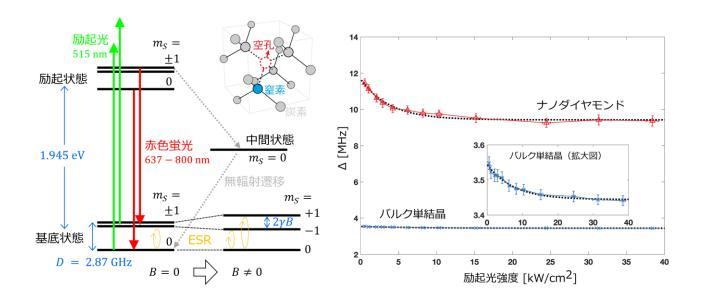
図左:ダイヤモンド結晶中の NV 中心とそのエネルギー準位の模式図。緑色の励起光によって赤色発光が起こること、基底 $m_s=\pm 1$ 状態は励起後に中間状態を経由して $m_s=0$ 状態に無輻射遷移する過程を持つこと、基底状態において ESR が可能であること、磁場中では ESR の共鳴周波数がゼーマン効果によって変化すること、などを概念的に示した。エネルギー間隔は模式的なものであり縮尺は正しくないことに注意。
