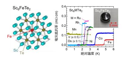
左図:  $Sc_6FeTe_2$ の結晶構造. 鉄 (Fe) 以外の磁性元素 M が含まれる場合も同じ結晶構造をとる. 右図: さまざまな磁性元素 M が含まれる  $Sc_6MTe_2$ の電気抵抗率と、アーク溶融法により合成された  $Sc_6FeTe_2$ の多結晶試料.
