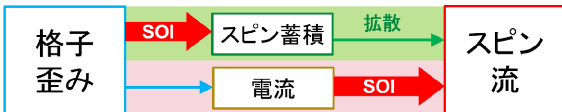
図1 スピン軌道相互作用を介した力学的スピン流生成の二つのメカニズム。 SOIはスピン軌道相互作用である。
