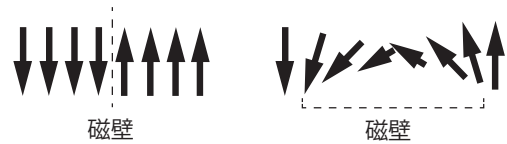
図4 厚さを持たない磁壁(左)と厚さを持つ通常の磁壁(右)。
