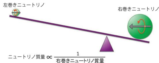
「右巻きニュートリノ」は極めて重いマヨラナ質量をもつことができ、「シーソー機構」(上図)とよばれる質量固有値の反比例関係を通して、我々の世界を飛び交っているニュートリノの質量を特異的に小さくすることができる。
