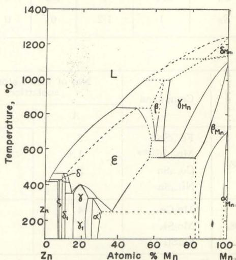
Fig. 1. Phase diagram of Mn-Zn system.<sup>5)</sup>
