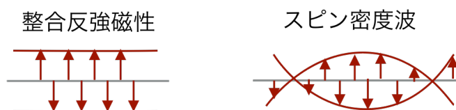
図1：整合反強磁性とスピン密度波の模式図 矢印の大きさが磁性元素上における磁気モーメントの強さを表している
