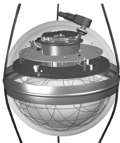
図3 アイスキューブ光検出器モジュールの図。球形の耐圧ガラス内、ワイヤ状の磁気シールドの内側に光電子増倍管が下向きに設置されている。上部2枚のドーナツ型円盤上に電子回路やキャリブレーション用のLED光源等が置かれている。(フルカラー口絵参照。)
