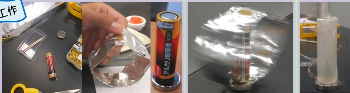
アルミ箔、電池、画鋲、ネオジウム磁石でファラデーモーターをつくりました。磁石にのせた電池にアルミ箔の輪をセットすると、アルミ箔が回りだしました。さらに銅線を使ったものでは、銅線が回りだしました。電気と磁気のエネルギーが回転運動へ変換されることを見ることができました。
