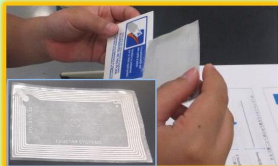
SuicaなどのICカードによるデータ送受信には電磁誘導（コイルのそばで磁石を動かすと、電力が誘起される現象）が利用されています。表面を剥がしたICカードに実際に触れ、コイルが入っていることを確認しました。
