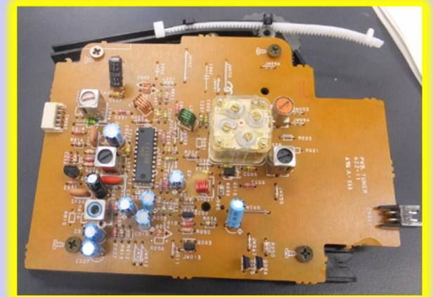
奥野先生が持参したラジカセの電気回路。今回は手軽に電気回路を組めるブレッドボードを用いて簡単な電気回路をつくり、電気によって音がでる仕組みを考えます。
